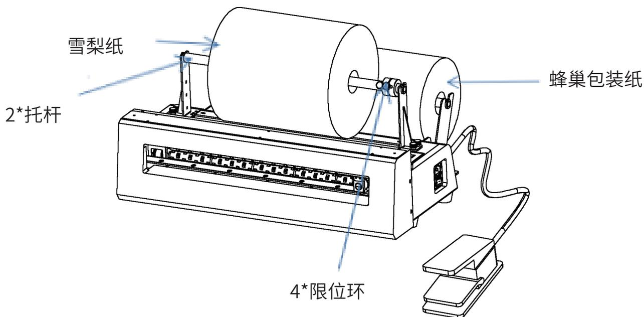
3、启动机器轻踩一次脚踏开关,然后把纸靠近滚筒,滚筒会自动吸入纸张,再轻踩一次脚踏开关滚筒会停止送纸并切纸一次
