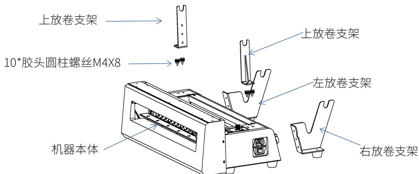
2、把蜂巢包装纸和雪梨纸套入托杆,并放入机器卡槽.然后接上电源与脚踏开关
